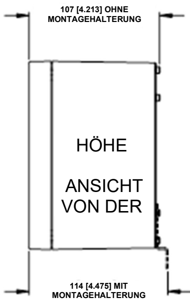
Abbildung 10: CT24-32 Maßzeichnungen für MCU-Gehäusebefestigung
