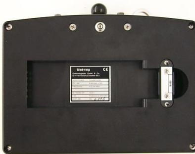
**Abbildung 6.2: Rückansicht Sender mit entnommenem Akku**
