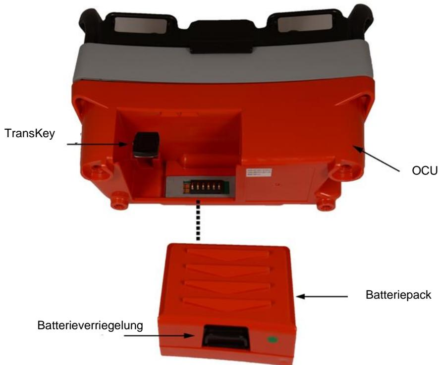
Abbildung 6: Entnahme des Batteriepacks
