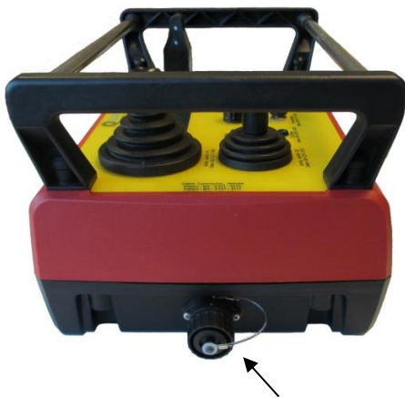
Linke Unterseite: Kabelanschluss
